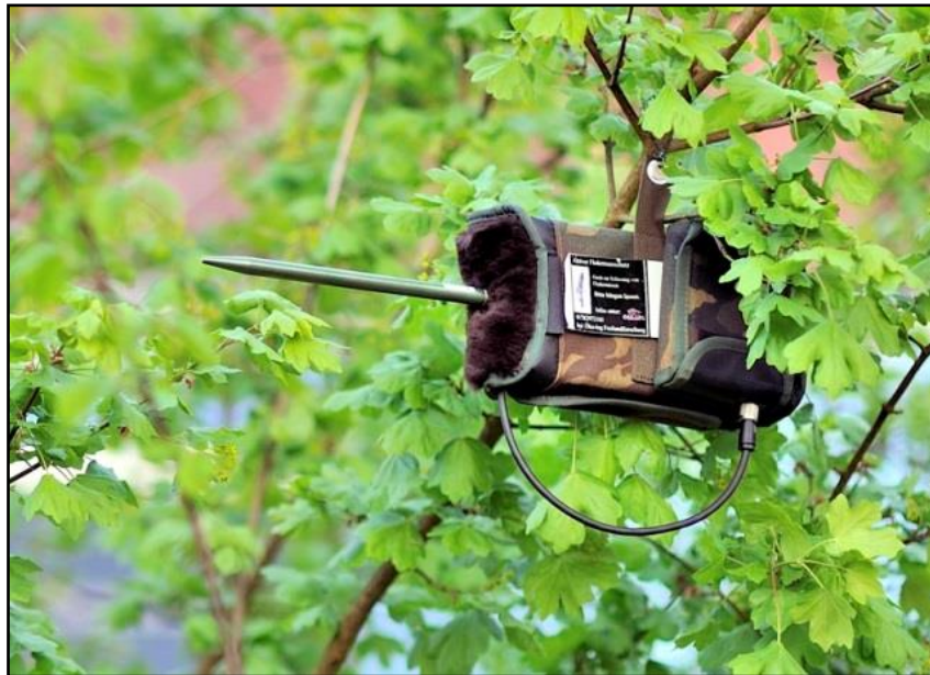
Abb. 8: Batcorder im Einsatz. Das Mikrofon befindet sich links an der Spitze des Stabes. Das Gerät wird im Rahmen der stationären automatischen Fledermauserfassung verwendet.
